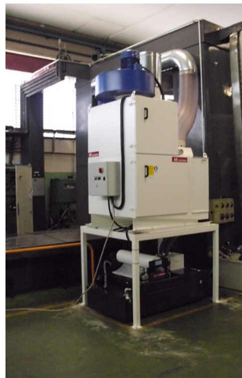
Installation de la série ARIS sur une aléseuse-fraiseuse
