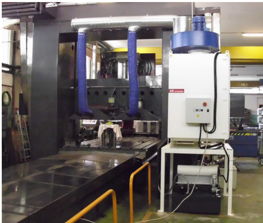
Installation de la série ARIS sur une aléseuse-fraiseuse
