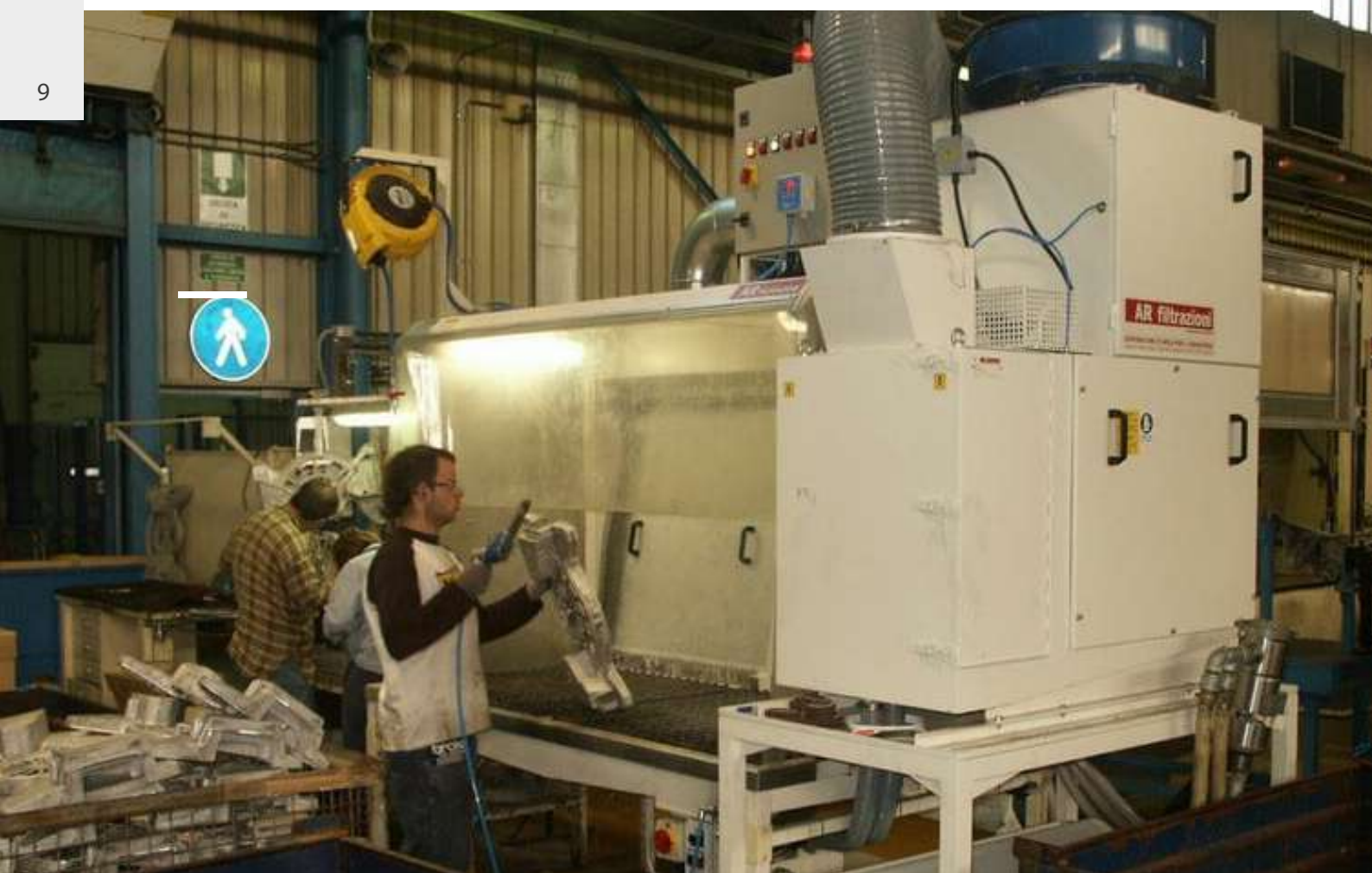
HYDROFILTER et HYDRODESK POUR LES PROCESSUS MANUELS DE D'ÉBAUVAGE À SEC DU MAGNÉSIUM
