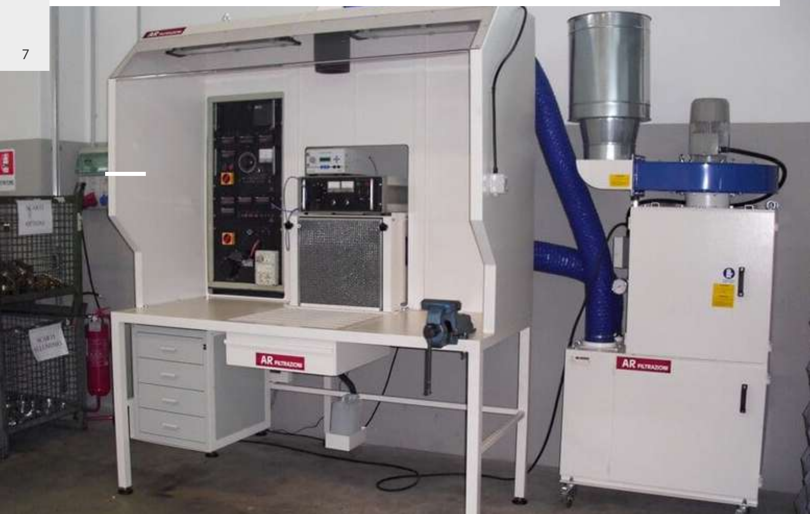
BANCS ASPIRANTS SPÉCIAUX, FABRIQUÉS SUR MESURE SELON LES SPÉCIFICATIONS DU CLIENT
