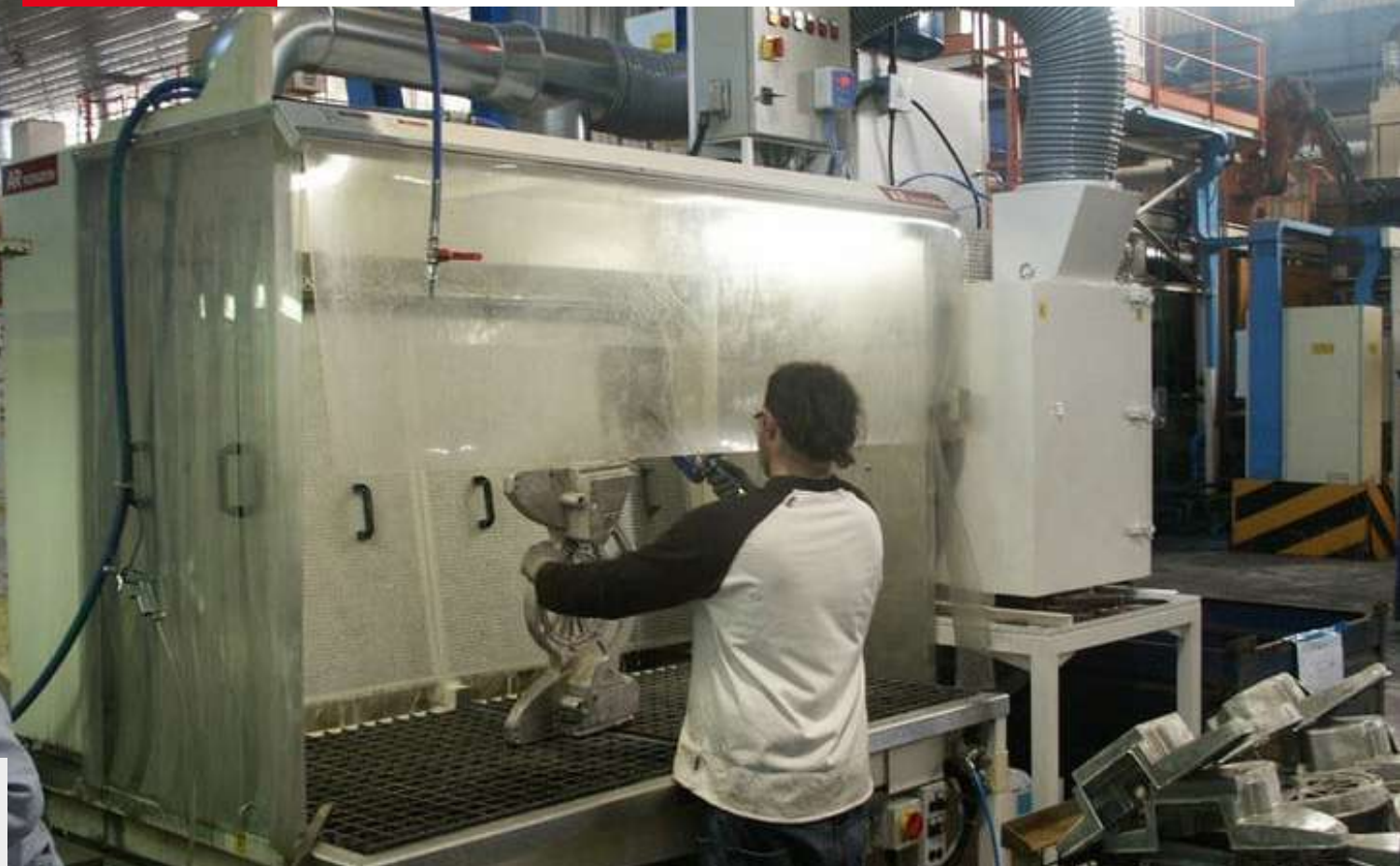
HYDROFILTER et HYDRODESK POUR LES PROCESSUS MANUELS DE D'ÉBAUVAGE À SEC DU MAGNÉSIUM
