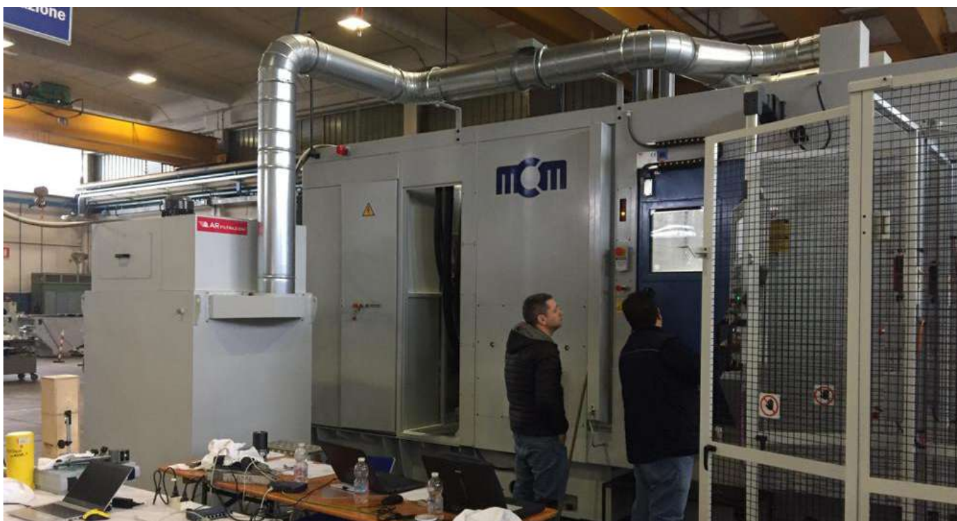
INSTALLATION COALFILTER SUR UN CENTRE D'USINAGE MCM
