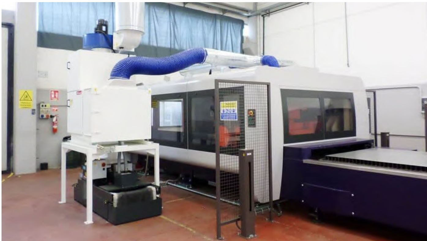
HYDROFILTER POUR LE DÉCOUPE PLASMA CNC
