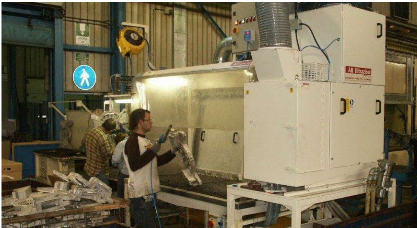
HYDROFILTER ET HYDRODESK POUR L'ÉBAVURAGE MANUEL À SEC DU MAGNÉSIMUM
